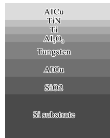
图 1 \text{Al}_2\text{O}_3 反熔丝结构图
